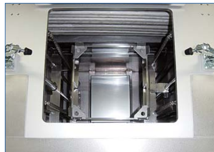
● 洗浄槽の内部
